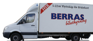
MB Sprint baklift 17,2 m 3 Flakmått: 410 cm x 210 cm Lasthöjd: 200 cm Maxlast: 880 kg Lastar: 17,2 m 3
